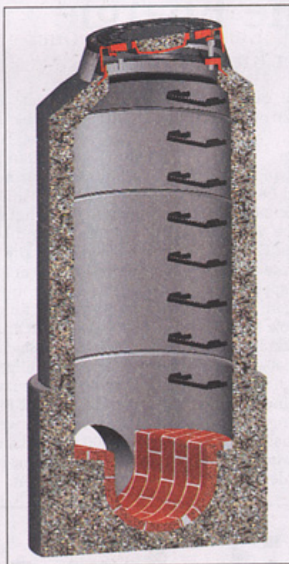
Schachtbauwerk mit optimaler Anordnung der Steighilfen. In der Praxis sehen sie oft anders aus. Bild: Econorm
