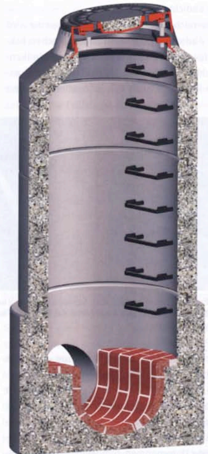
Das ideale Schachtbauwerk mit nachgiebigen Bauteilverbindungen.
