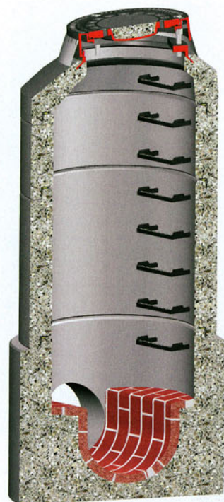
Ein ideales Schachtbauwerk mit nachgiebigen Bauteilverbindungen.
