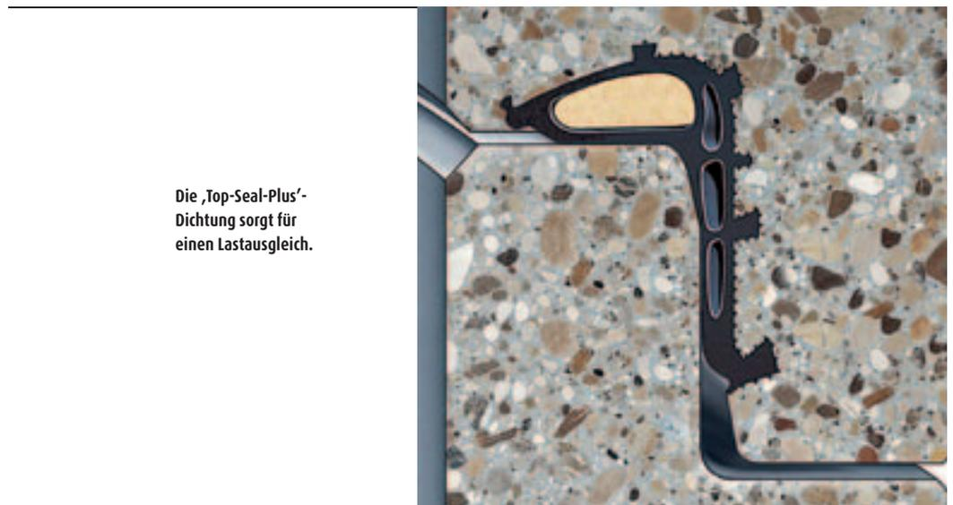
Die ‚Top-Seal-Plus‘-Dichtung sorgt für einen Lastausgleich.
