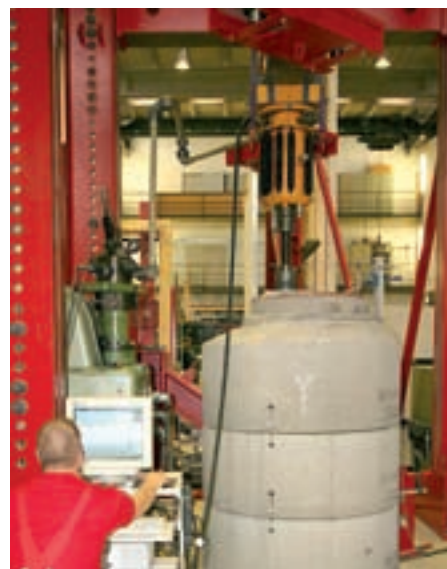
Realitätsnahe dynamische Vertikalbeanspruchung: Prüfung der Dauerbelastbarkeit eines econorm Schachtes an der TU Braunschweig.
